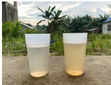
Gambar 5. Hasil Air Sesudah dan Sebelum Filtrasi
