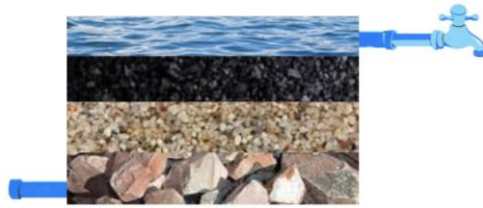
Gambar 4. Susunan Bahan Material Bak Filtrasi (Sumber: Diolah oleh penulis)
